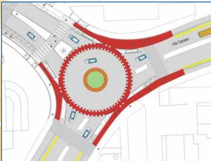
**Figura 7** – Rotatoria compatta con aiuole di protezione e corsia di attraversamento (1 metro di larghezza netta) per ciclisti in anello, ingresso e uscita della rotatoria.
