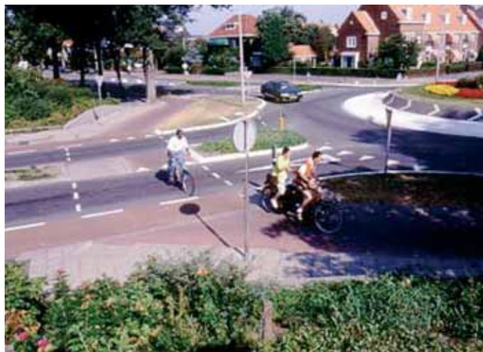
**Figura 13** – Rotatoria compatta con aiuole di protezione e pista ciclabile monodirezionale separata e protetta. Il ciclista deve dare la precedenza ai veicoli a motore (Olanda).
