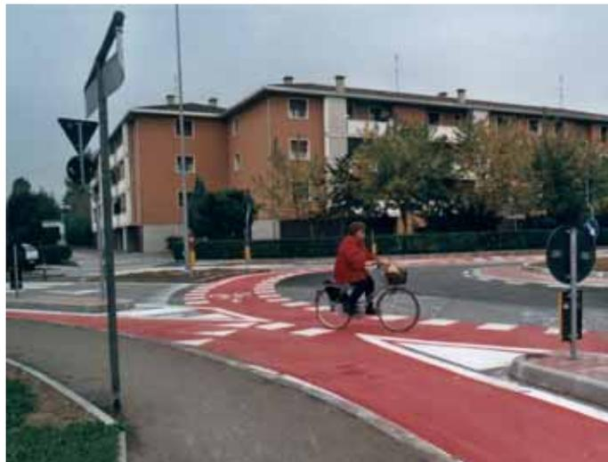
**Figura 8** – Rotatoria compatta con aiuole di protezione e corsia di attraversamento per ciclisti in anello, ingresso e uscita. Le precedenze dei ciclisti sono regolate come per gli autoveicoli. La scelta di trattare l'anello ciclabile come attraversamento ha lo scopo di garantire la precedenza anche nei rami stradali di uscita.
